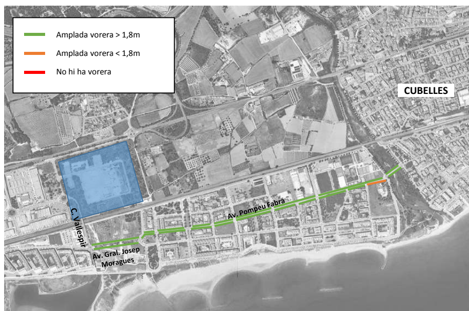
Figura 49: Amplada de voreres a l'itinerari principal d'accés des del nucli urbà de Cubelles
